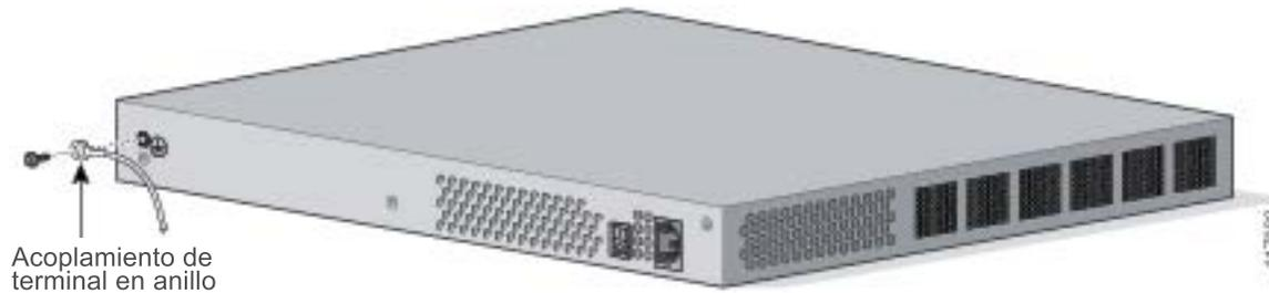
**Figura 11** Conexión de toma de tierra del chasis compatible con NEBS del chasis de Cisco 2811
